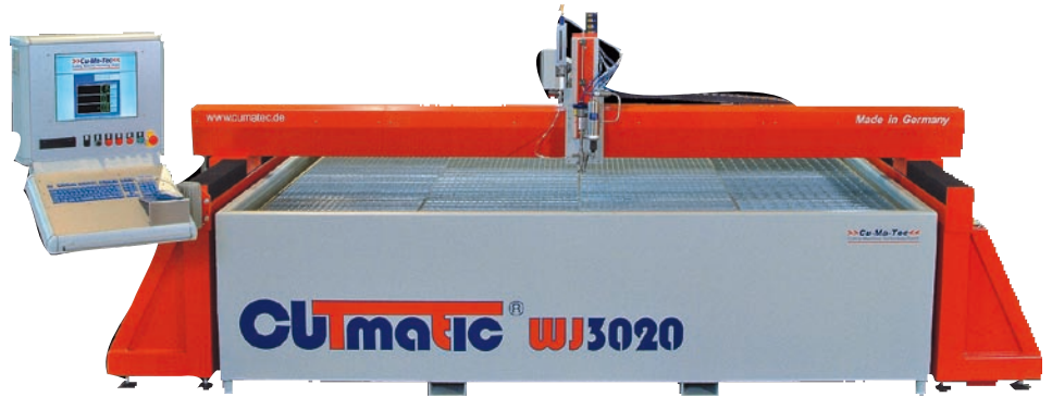
3: Das Maschinenportal der Wasserstrahlchneidmaschinen der CuTmatic-WJ-Baureihe wird von zwei Hohlwellenantrieben im Gantry-Betrieb bewegt.
